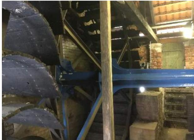
Abbildung 136: repariertes Wasserrad- Mühle Dambeck © Prof. Gerhard Müller
